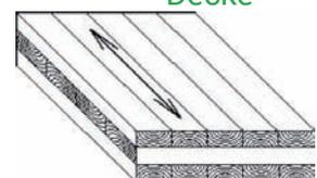
Orientierung der Decklage = l = längs = Länge/Höhe des Bauteils
